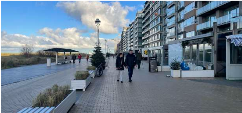
FIGUUR 91: Nieuwpoort - Een opdeling van de dijk door enkele lijnelementen (banken, bloembakken, ...) en verschil in stroken materialisatie zorgt voor een opdeling van de brede dijk.
